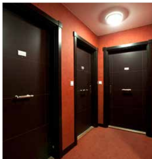
Portes Palières blindée AXIOME Coupe-feu EI30, Climat 3c, Acoustique Rw39
